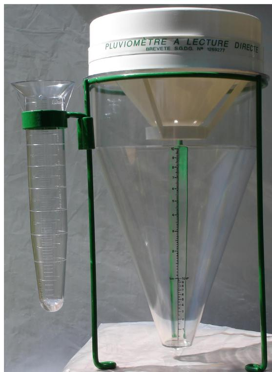
Ce type de pluviomètre permet une lecture rapide de la quantité de pluie. Il permet d'apprécier avec précision la hauteur d'eau apportée au sol à l'endroit où il est installé.
